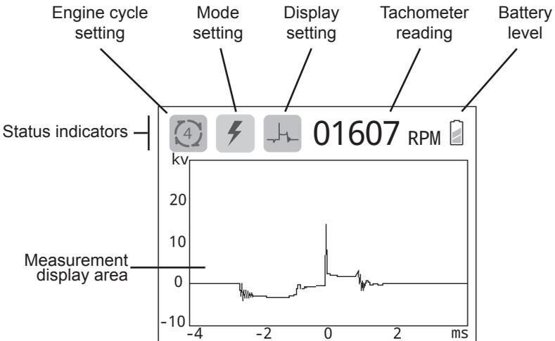
Fig. 2 - LCD Display
